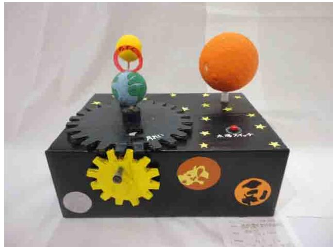
太陽スイッチを押すと、太陽に埋め込まれたライトが光ります。箱の横についている黄色いギアを回転させると、地球と月が回転し、地球から月がどのように満ち欠けするかを見ることができます。さらに黒いギアが回ると「三日月」「満月」などの表示が現れて確認することもできます。ギアの回転で月の状態を表示する仕組みや完成度などが高く評価されました。
