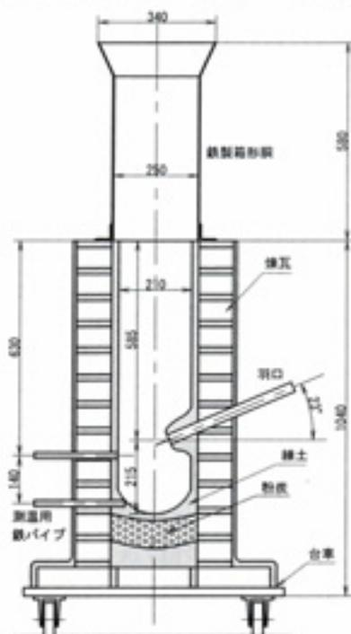
第2図 炉の構造
